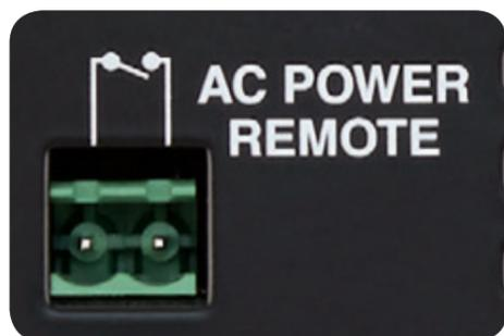
distance En utilisant la borne AC REMOTE à l'arrière du produit, vous pouvez mettre l'alimentation des amplificateurs DPS sur ON / OFF à distance. Lorsque le contact REMOTE est ouvert, l'amplificateur est allumé. L'amplificateur est éteint lorsque le contact est fermé.
