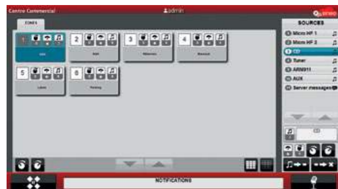
Effectuer le matriçage des sources vers n'importe quelle zone Gérer les niveaux d'entrée et les volumes des zones
