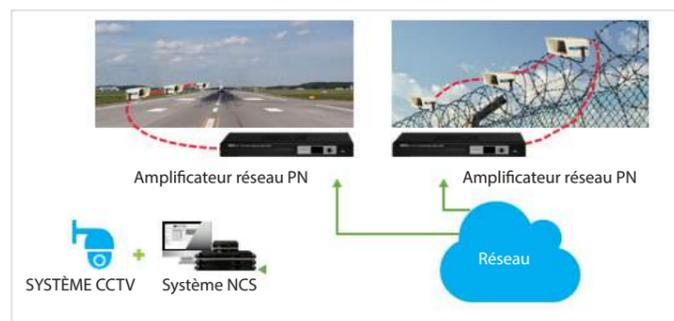
En connexion avec le réseau de vidéosurveillance, il est possible de diffuser des alertes et des annonces dans une zone étendue. Lorsqu'un intrus s'introduit, il reçoit le signal d'avertissement de la zone et il est possible de transmettre l'avertissement à la zone par la génération automatique de son depuis le système principal du système NCS.
