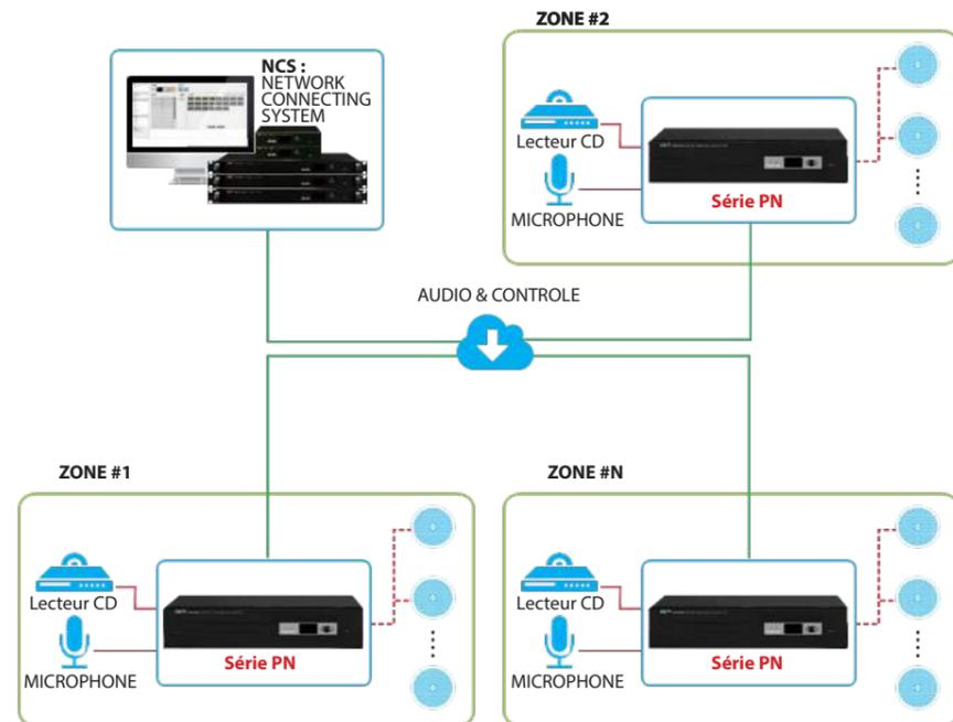
En se connectant au système NCS, qui est le système de diffusion principal via le réseau, la diffusion dans chaque zone locale est possible. Les amplificateurs sur réseau PN prennent en charge les environnements LAN et WAN, permettant ainsi une réception audio dans les zones distante ou locale.
