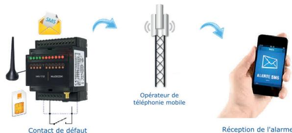
Envoi d'une alarme par SMS, Mail ou Message vocal en cas de déclenchement d'un contact sec électrique de dépassement de seuil d'une entrée analogique ou de coupure de l'alimentation secteur.
