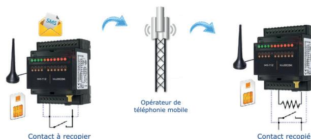
Application point à point entre 2 transmetteurs SMS-112 (+ cartes SIM). Lorsqu'un contact change d'état sur le SMS-112 n°1, il envoie une commande au SMS-112 n°2 pour fermer une de ses sorties.
