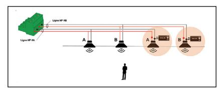
L'EOL-20 doit être connecté en fin de ligne et sur chaque ligne haut-parleurs. Les deux fils n'ont pas de polarité et peuvent donc être connectés dans un sens comme dans l'autre.
