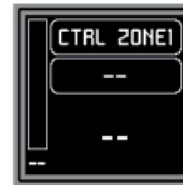
Une pression longue (supérieure à 5 secondes) sur la commande rotative affiche les paramètres de configuration de la platine : nom, modèle, version du firmware et paramètres de connexion au réseau Ethernet :
