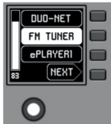
Lorsqu'on tourne la commande rotative **K5** pour modifier le volume qu'elle contrôle, un autre écran s'affiche de façon temporaire, l'écran antérieur ou principal revenant après quelques secondes. Exemple :
