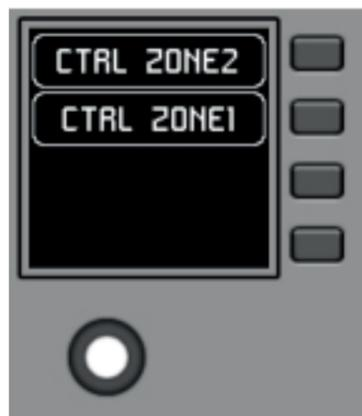
Dans l'exemple précédent, on voit qu'il y a deux choix de panneau possibles pour le panneau MULTI : CTRL ZONE1 et CTRL ZONE2. Avec K1 et K2, il est dans ce cas possible de sélectionner l'un ou l'autre. Exemple de sélection du panneau individuel CTRL ZONE2 (touche K2) :
