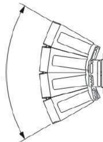
L'illustration montre le système d'enceintes avec un angle de directivité réglé à 60° (paramètres d'usine).
