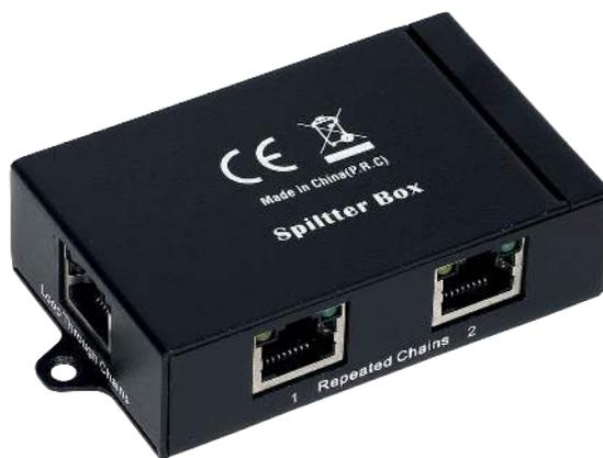
• Ce répartiteur RJ45 permet de rajouter sur une boucle ou un bus de pupitres de conférence une partie en étoile comme dans l'exemple ci-dessous :
