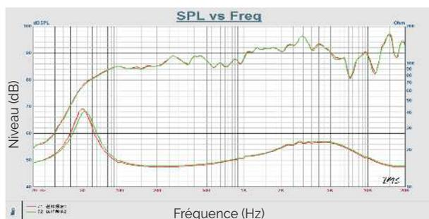
Bande passante suivant réglage de puissance
